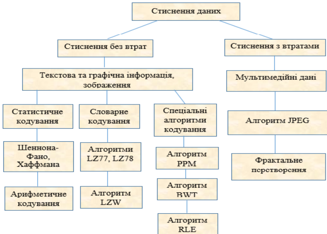
Рисунок 2.1 – Схема стиснення даних
