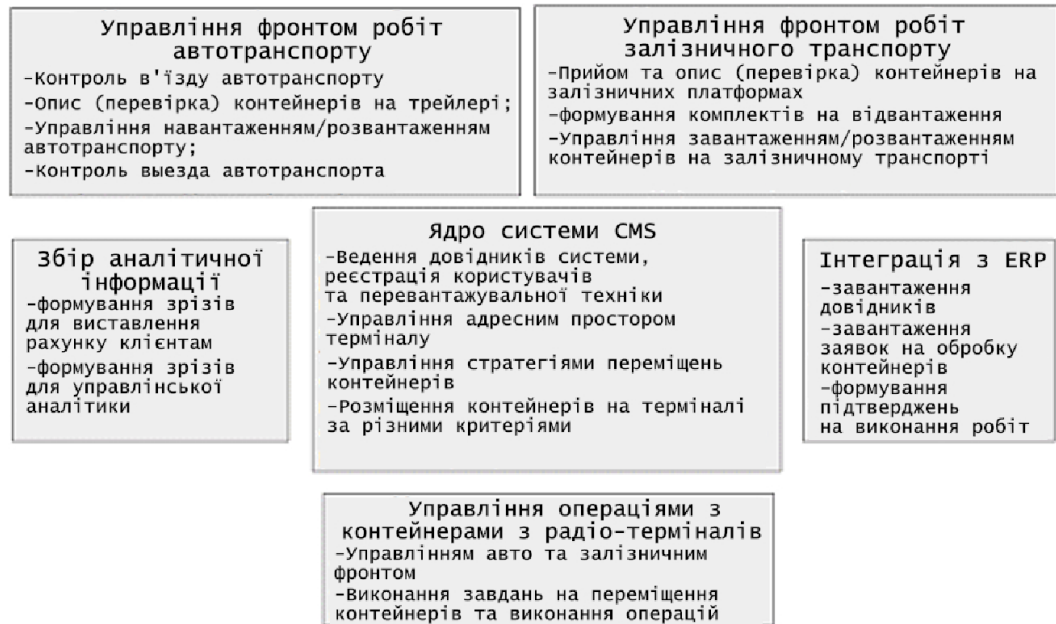
Рисунок 2 – Функціональна схема системи керування контейнерним терміналом
