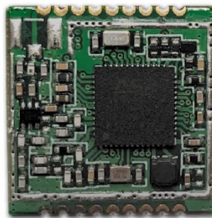
Рисунок 3.3 – Зовнішній вигляд LoRaWAN- модуля RFM6501W
