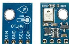
Рисунок 2.5 – Зовнішній вигляд модуля з датчиком АНТ10
