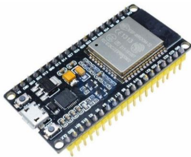
Рисунок 2.1 – Зовнішній вигляд налагоджувальної плати з модулем ESP32
