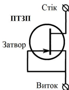
Рисунок 3.3 – Схема двополюсного включення ПТЗП
