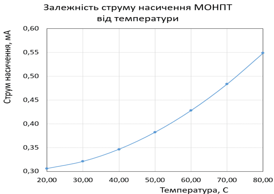
Рисунок 3.9 – Залежність струму насичення МОПТ від температури
