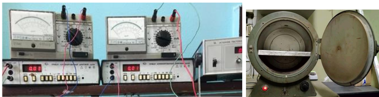
Рисунок 2.2 – Лабораторна установка для вимірювання вольт-амперних характеристик ОПТ а) та лабораторна піч б)
